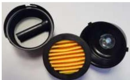
При забивании фильтра всасывающей линии необходимы прочистка или замена гофрированного бумажного элемента. Периодичность этой процедуры сильно зависит от загрязненности окружающего воздуха. На ее необходимость может указать снижение его производительности.
